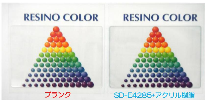
塗工方法：スピナーにて硝子板に塗工。
